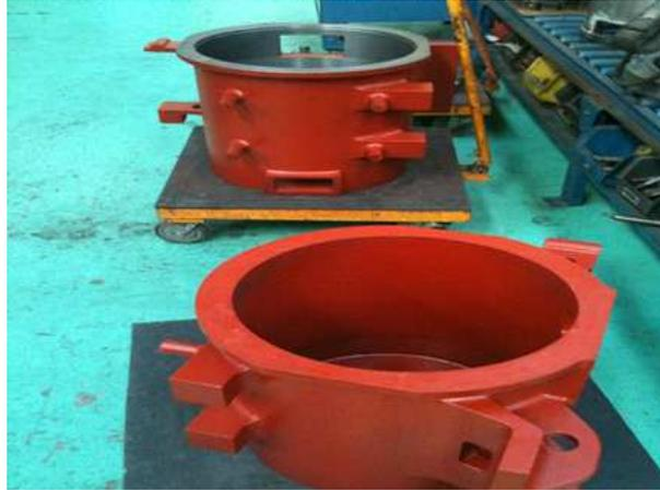
Figura 2.6: Motor maquinado segundo proceso (parte superior) y motor sin maquinar (parte inferior).
