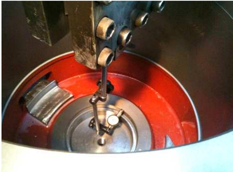
Figura 4.15: Ajustes de la pieza para segundo proceso
