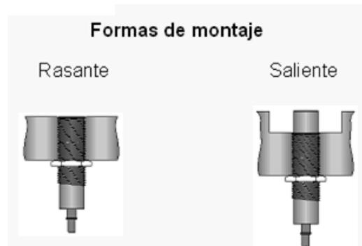
Figura 77 Tipo de montaje
