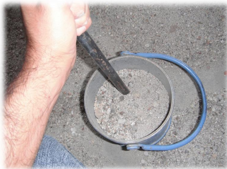
Figura 3.5.- Varillado de arena para la prueba MVSV.
