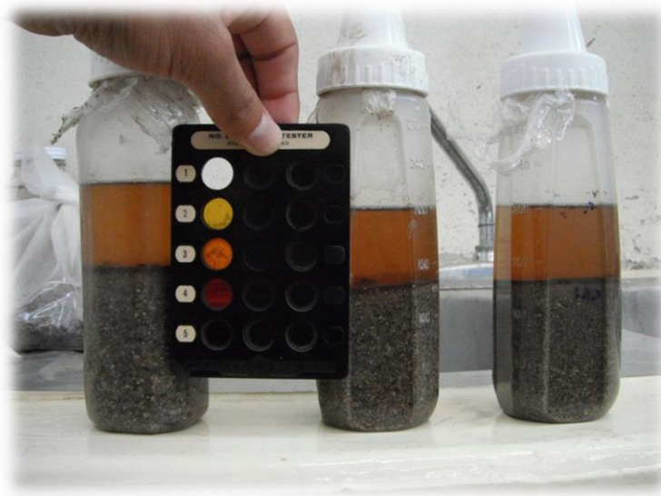
Figura 3.6.- Prueba de colorimetría.
