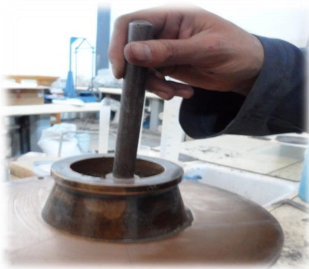
Figura 3.19.- Apisonamiento de la mezcla.
