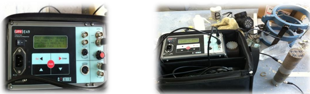
Figura 3.35.- Equipo para medir la velocidad de pulso ultrasónico, CONTROLS.
