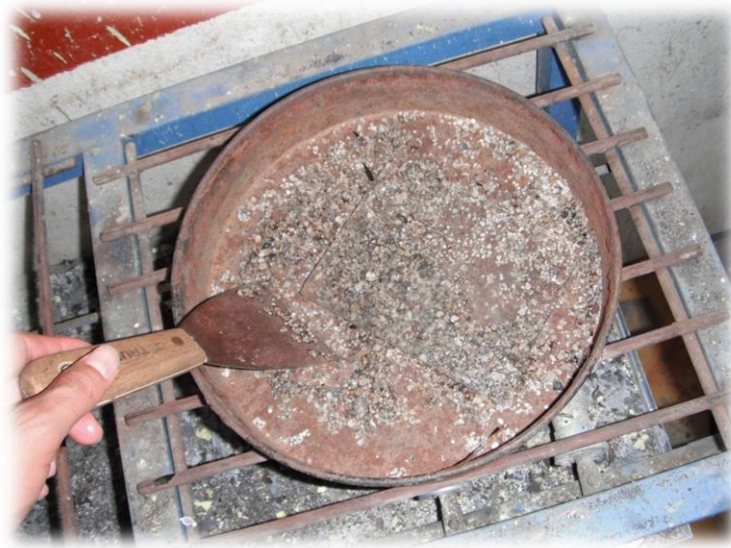
Figura 3.2.- Secado de la arena.
