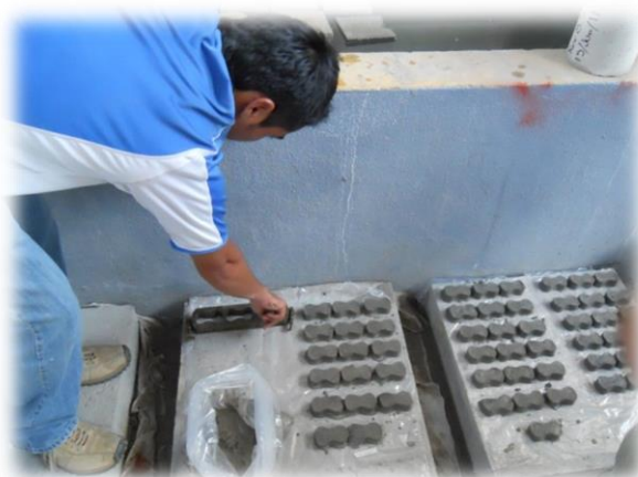
Figura 3.27.- Elaboración de briquetas.
