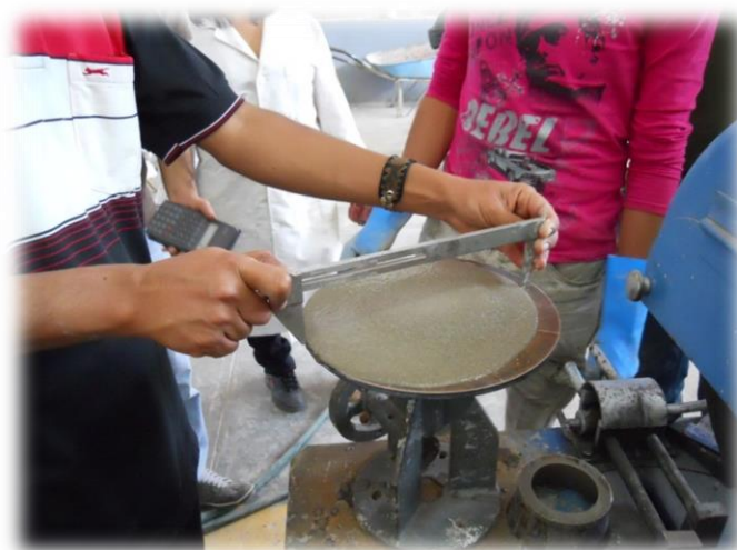
Figura 3.20.- Medición del diámetro de la mezcla sobre la mesa de fluidez.
