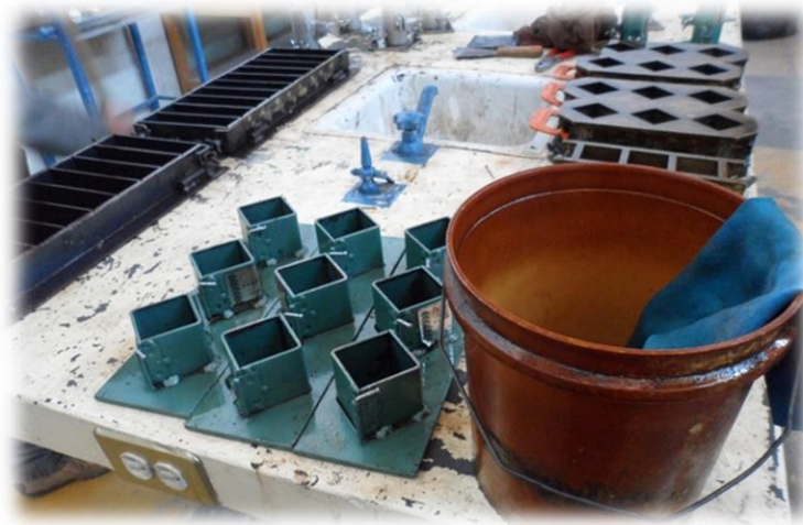
Figura 3.23.- Engrasado de Moldes
