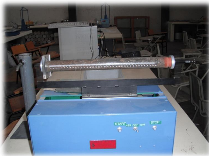
Figura 3.8.- Equipo de realización de Equivalente de arena.
