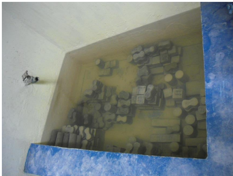
Figura 3.25.- Pila de curado.
