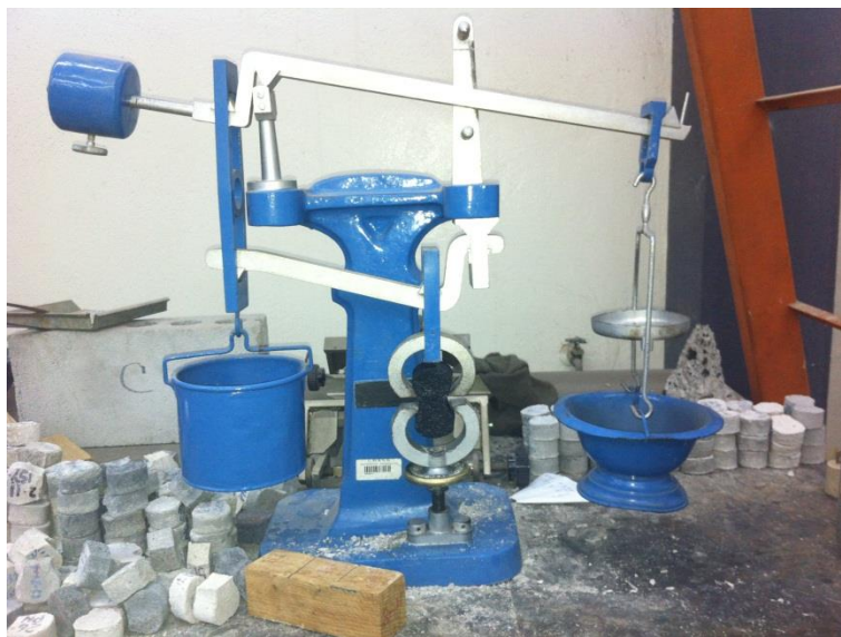
Figura 3.39.- Tensión en briquetas, máquina Michellis.
