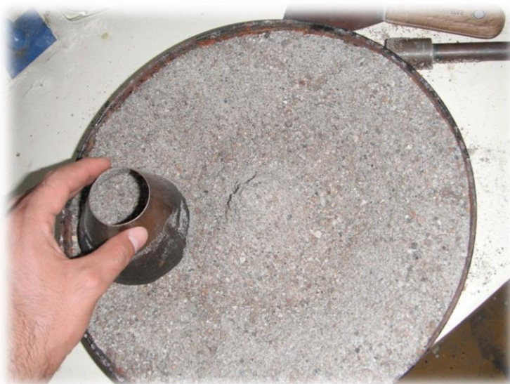
Figura 3.3.-Realización de la prueba de Humedad de absorción.
