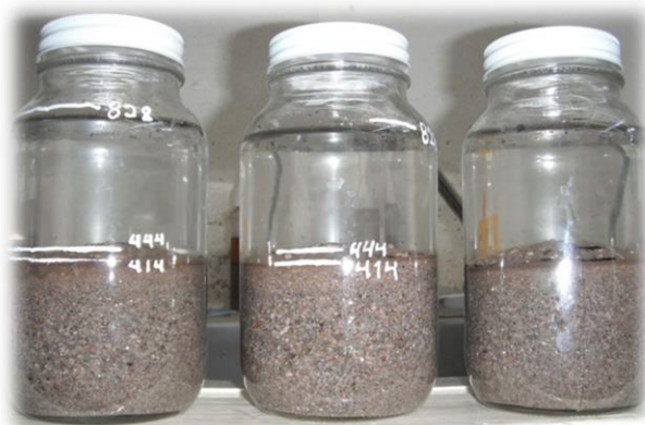
Figura 3.7.- Prueba de sedimentación
