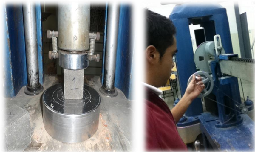
Figura 3.37.- Colocación y prueba del espécimen cúbico para prueba de compresión.
