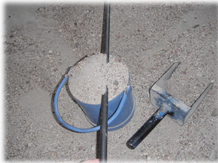
Figura 3.4.- Prueba de MVSS
