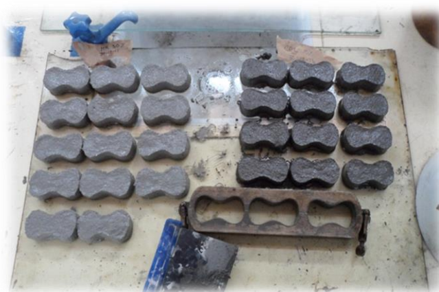
Figura 3.28.- Equipo para la elaboración de briquetas.
