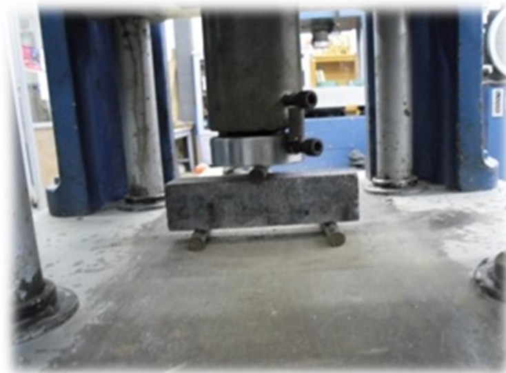
Figura 3.38.- Prueba a flexión en primas.
