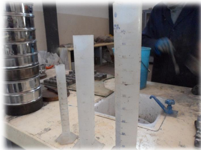
Figura 3.10.- Probetas donde se midió el agua a utilizar.
