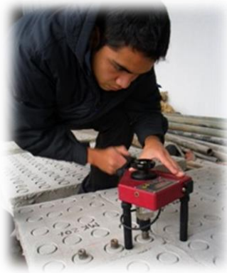
Figura 3.42.- Realización de las pruebas de adherencia.
