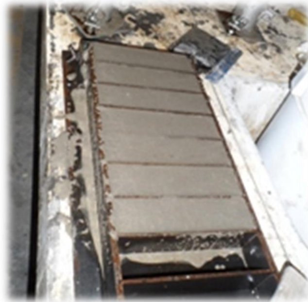
Figura 3.26.- Especímenes prismáticos elaborados.
