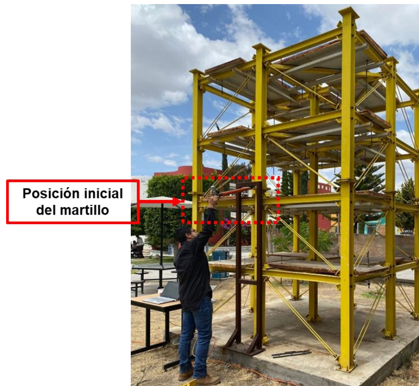
Figura 4.4. Estado inicial para impacto de la estructura.
