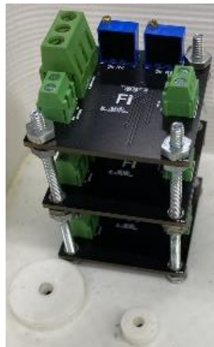
Figura 3.29. Arreglo de placas de acondicionamiento.
