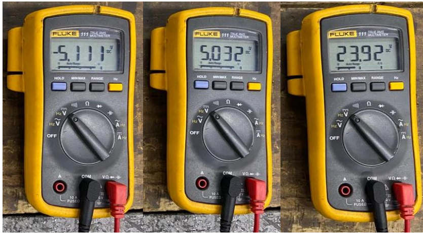
Figura 3.8. Medición de los voltajes de salida de la fuente de poder.
