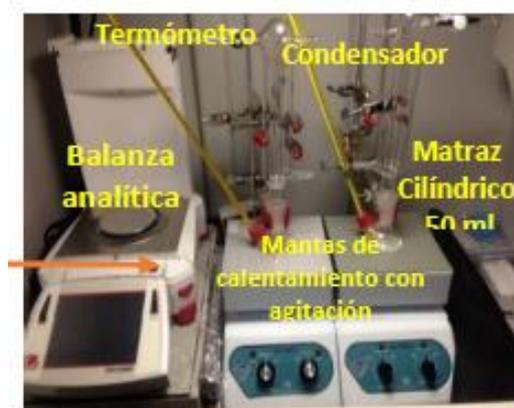
Figura 23: Instrumentación en la cámara de guantes del laboratorio en nanoestructuras del CINVESTAV, Ciudad de México, adecuado por el doctor Daladier A. Granada Ramírez.
