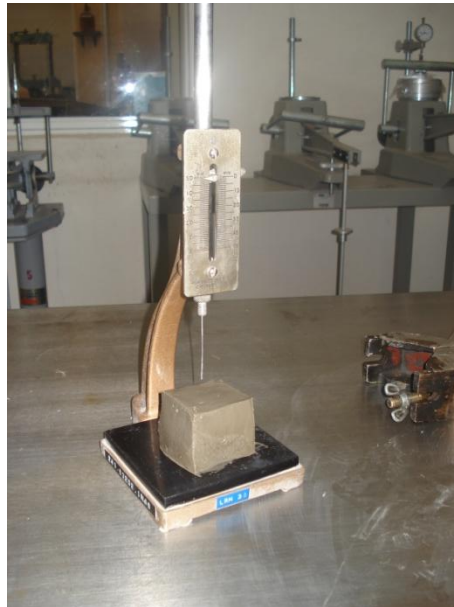
Figura 15 "Prueba para determinar el fraguado inicial y final"
