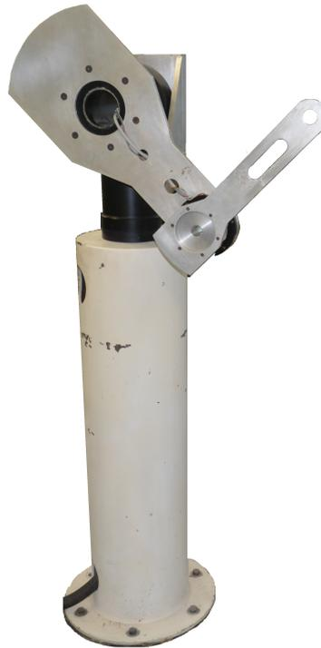
Figura 2.10: Robot experimental de transmisión directa de 3gdl.
