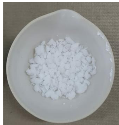
Figura 19. Partículas de sílice mesoporosa sin cargar.
