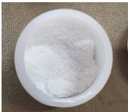
Figura 18. Partículas de sílice molidas
