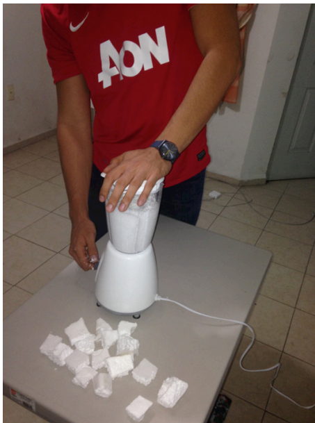
Figura 11. Triturado del poliestireno por medio de licuado.
