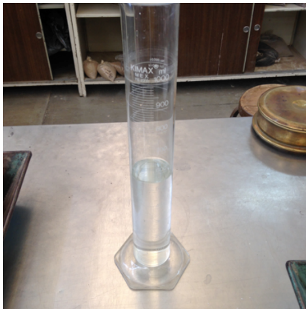
Figura 15. Probeta 1000 ml. utilizada para medir el agua (Foto tomada en la UAQ).
