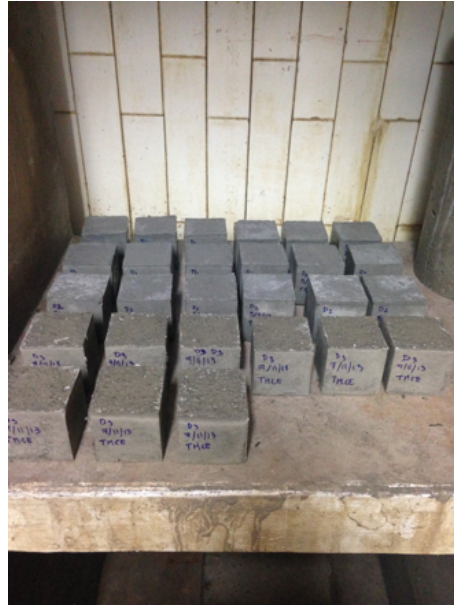
Figura 26. Curado de los especímenes en cuarto húmedo (Foto tomada en la UAQ).
