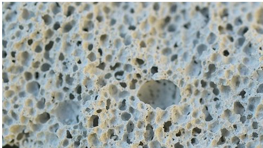
Figura 7. Cavidades del mortero celular originadas por burbujas de aire (D'Annunzio, 1963).
