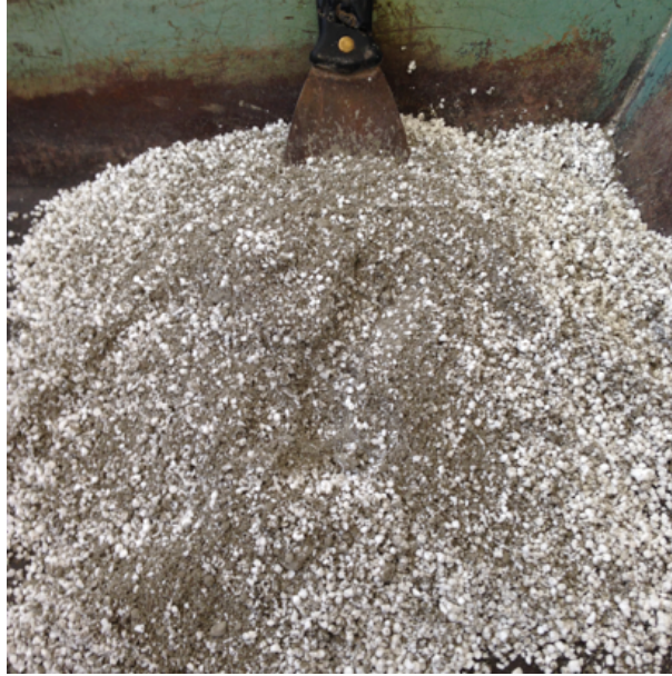
Figura 20. Cemento y poliestireno homogenizado (Foto tomada en la UAQ)
