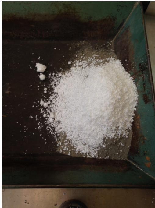
Figura 19. Se agregará poliestireno al cement(Foto tomada en la UAQ) .
