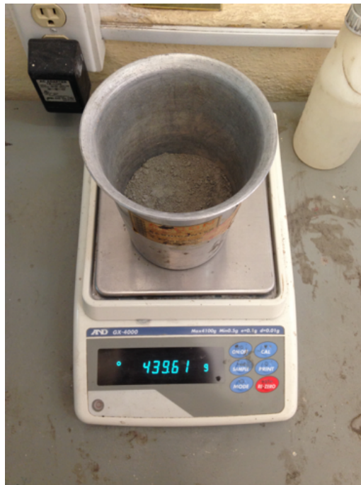
Figura 13. Báscula digital, utilizada para pesar el cemento(Foto tomada en la UAQ).
