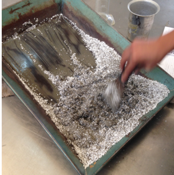
Figura 22. Mezcla de las pasta con el poliestireno (Foto tomada en la UAQ).
