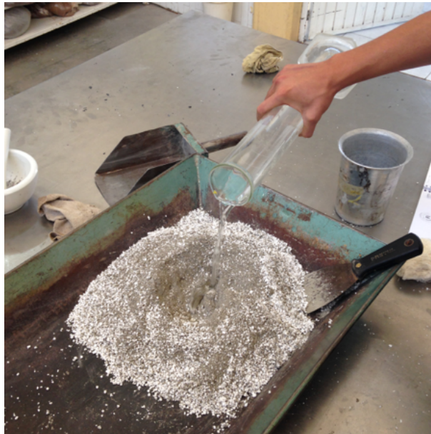
Figura 21. Agregado del agua al cemento con poliestireno. (Foto tomada en la UAQ).
