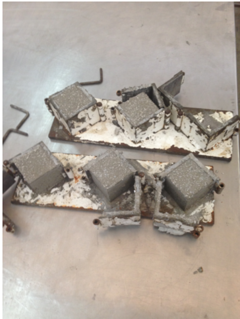
Figura 25. Descimbrado de cubos. (Foto tomada en la UAQ).
