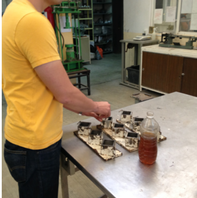
Figura 16. Moldes cúbicos de 5 cm por lado engrasados (Foto tomada en la UAQ).
