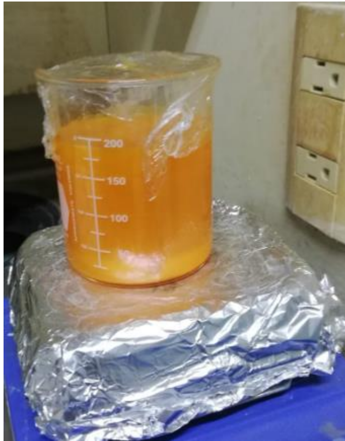
Figura 18. Reactor en donde se está realizando el baño químico para obtener una película delgada de CdS.
