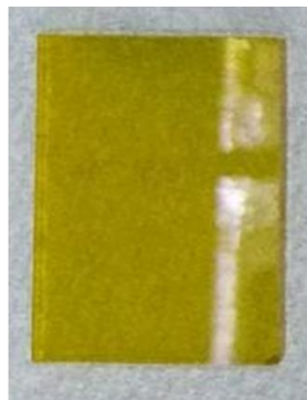
Figura 19. Película de CdS obtenida por baño químico ( CBD ).
