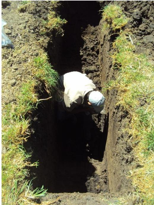
*Figura 3.6 Vista de Obtención de humedades a distintas profundidades (PCA-1)*
