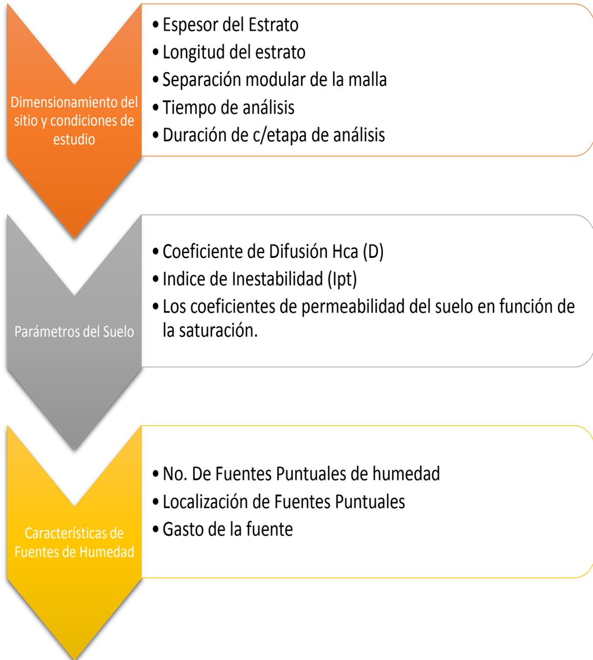
Figura 3.11 Esquema de Datos de Entrada al Programa en ANSYS
