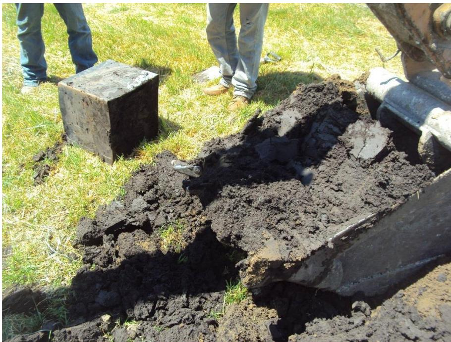
*Figura 3.7 Vista de muestreos alterados e inalterados de arcilla expansiva (PCA-1)*
