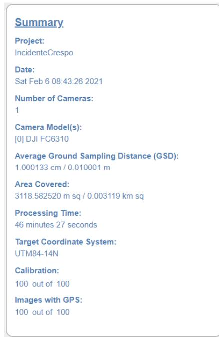
Figura 6-12 Resumen de procesamiento fotogramétrico realizado con Recap Photo versión 2021 para el evento con clave IN210130\_01
