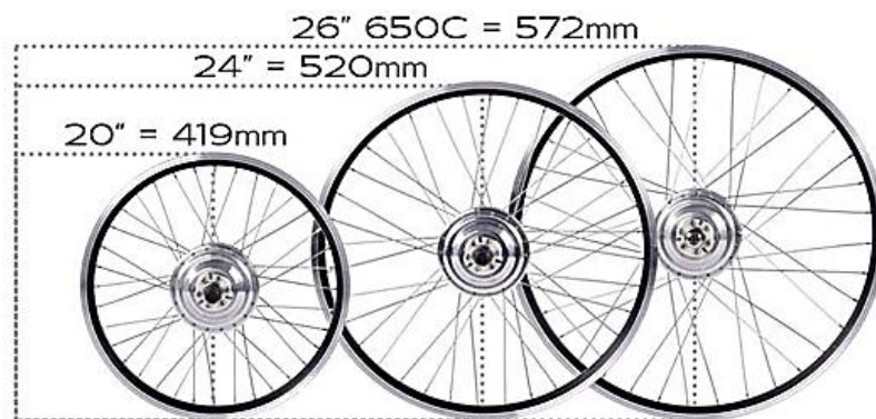
Figura 3.21 Dimensiones de ruedas de bicicleta [47]
