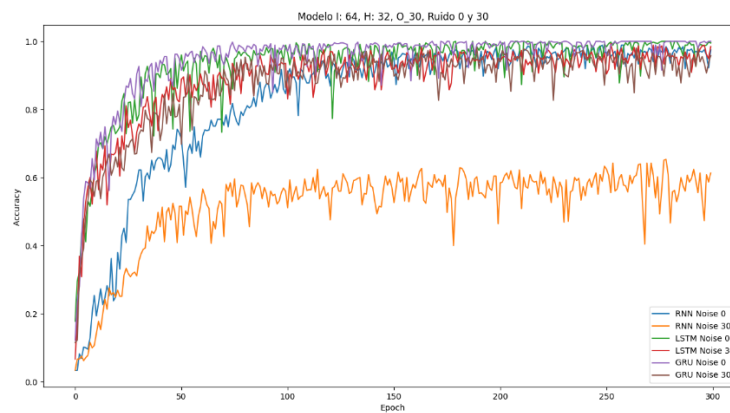
Figura 17: Curvas de entrenamiento para modelos con 64 neuronas en la capa de entrada y 32 neuronas en la capa de salida.
