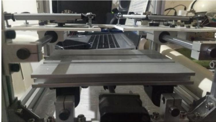
Figura 30. En la parte inferior de la imagen, se puede observar la parte uno de la estructura dedicada a la sujeción de la fibra óptica de vidrio; en la parte superior se puede observar la placa para el soporte de los ejes de los electrodos.
