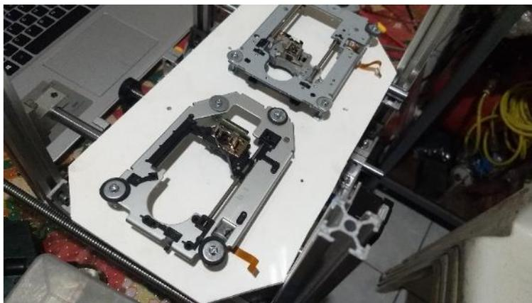
Figura 29. Segunda parte de la estructura para el movimiento del arco eléctrico. También se observan los ejes para electrodos sobre plataforma.
