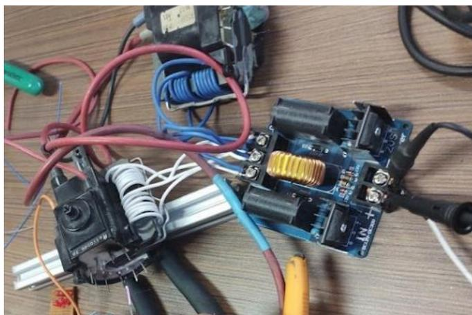
Figura 38. Integración de dos transformadores *flybacks* con salidas en serie para la generación del arco eléctrico.
