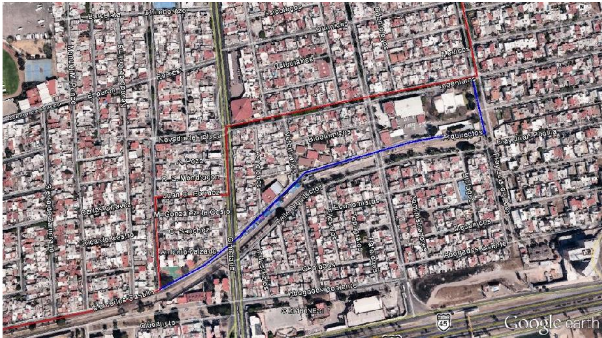
Figura 5-6 Corrección de cuencas urbanas calle a calle considerando la pendiente mostrada en Google Earth PRO
