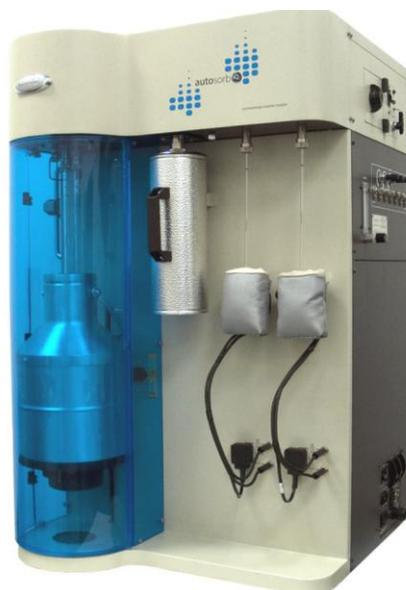
Figura 3-3. Equipo Quantachrome iQ2 para la determinación de las isothermas de adsorción-desorción.
