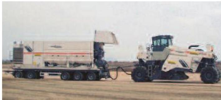
Figura 2-5. Equipo de estabilización por vía húmeda con despósito para conglomerante de 25 m<sup>2</sup> (Atienza, 2008)
