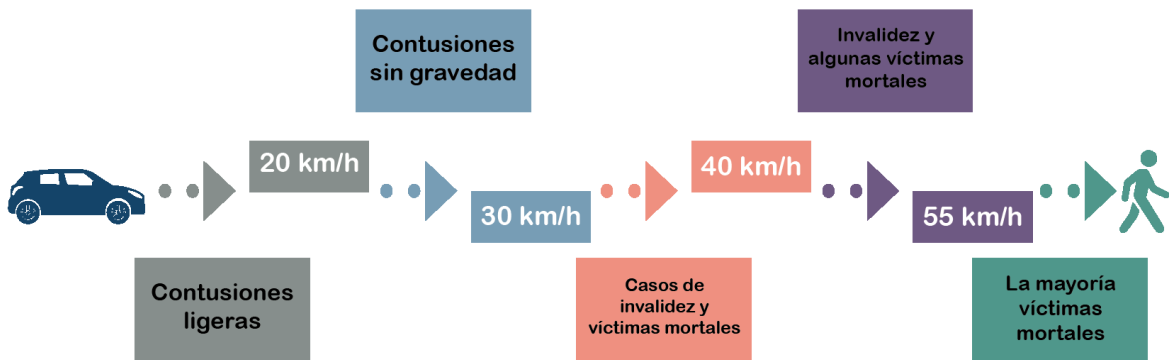
Figura 24. Relación entre la velocidad y la gravedad de los atropellos (Adaptación, tomada de Movilidad Urbana Sostenible: Un reto energético y ambiental , pág. 61)
