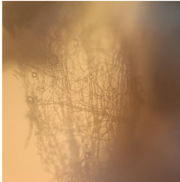
Figura 20. Fotografía de microscopio óptico (a 40X) de la membrana de quitosano-colágeno, datos EXIF: f/1.89, 1/30 e ISO900.
