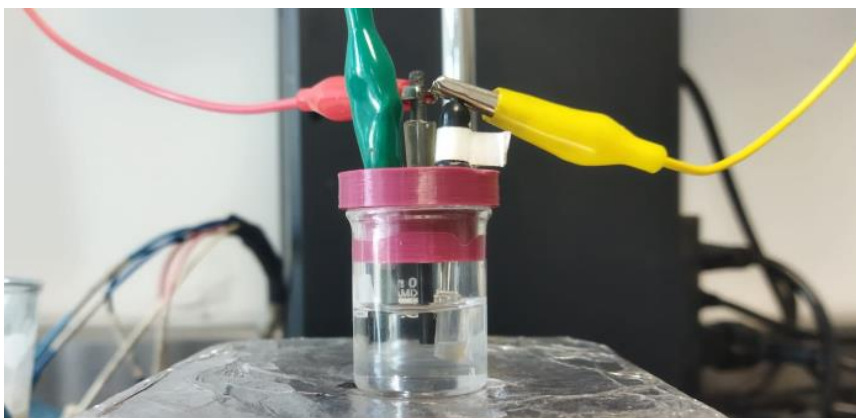
Figura 20 Sistema de configuración de tres electrodos.
