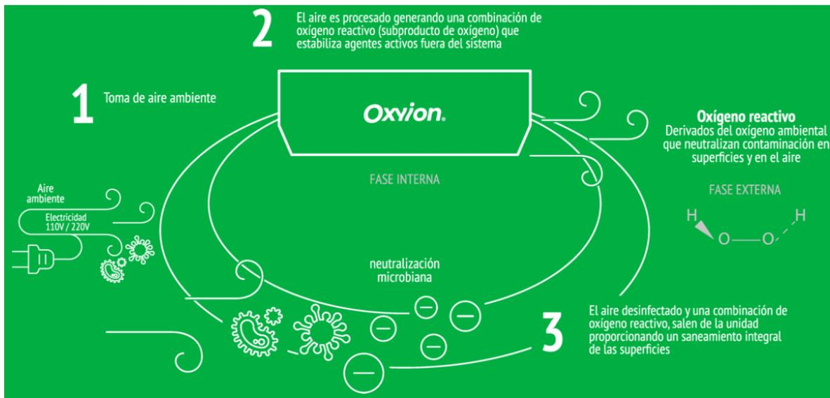
**Figura 5.** Mecanismo de acción del equipo Oxyion
