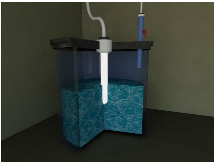
Figura 3.10 Esquema para la evaluación de la actividad fotocatalítica
