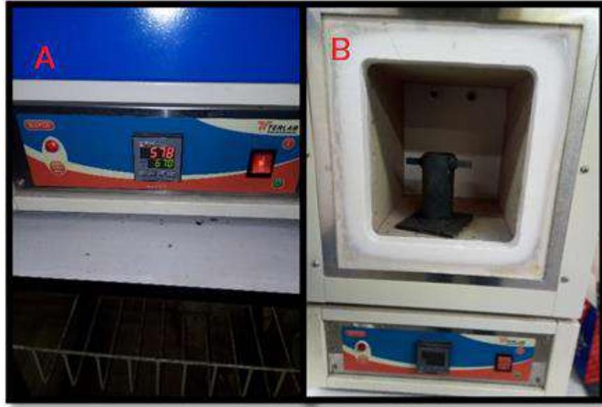
**Figura 3-13. A) Pre calentado de la mufa a 670°C y B) Aluminio fundido previo al vaciado.**
