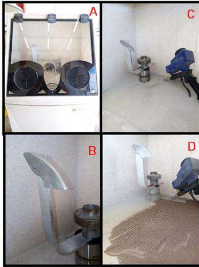
**Figura 4-14. A) Cabina de sandblasteo B) Prototipo fijo en la base de soporte C) Alineación a 30° previo a la aplicación del erosionante y D) Pieza erosionada.**
