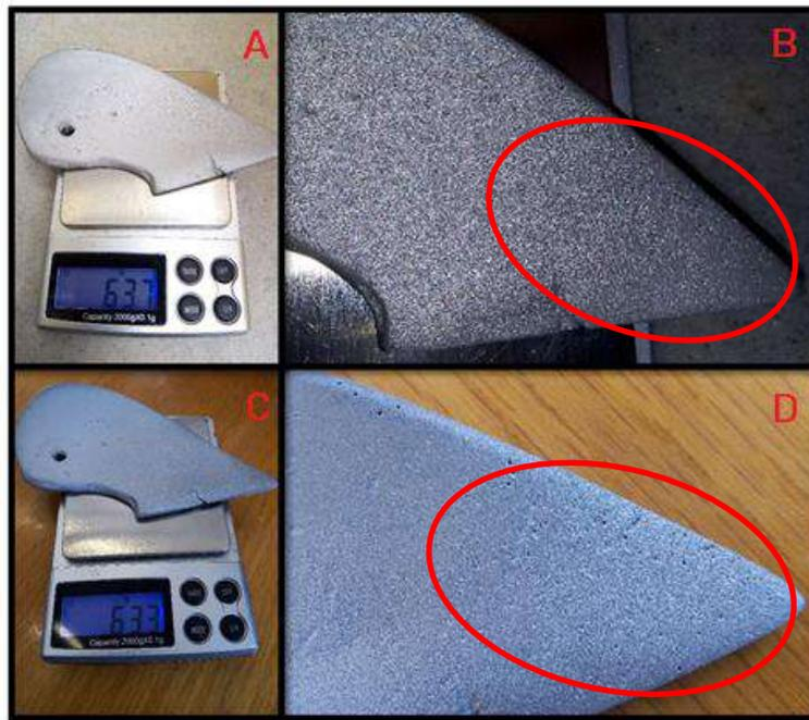
**Figura 4-16. A) Pesaje del primer experimento de sandblasteo B) Exposición de la zona afectada del primer experimento de erosión C) Pesaje final del prototipo desgastado y D) Exposición de la zona desgastada final.**
