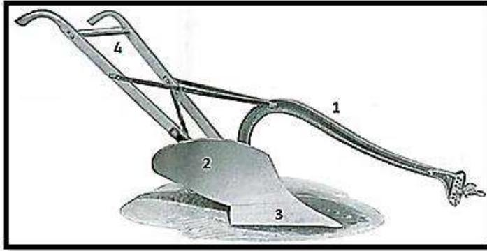
**Figura 1-1. Elementos que componen el cuerpo de un arado 1) Bastidor 2) Vertedera 3) Reja 4) Timón (Rehkugler, 2011).**
