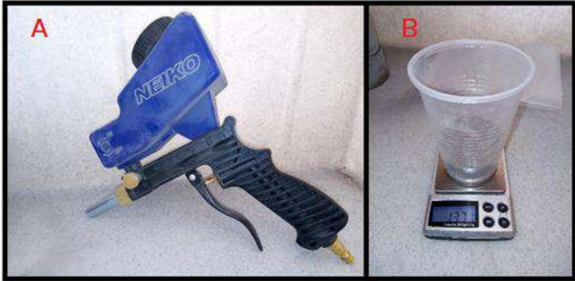
**Figura 4-13. A) Pistola de *Sandblast* utilizada y B) Pesaje del óxido de aluminio (erosionante).**
