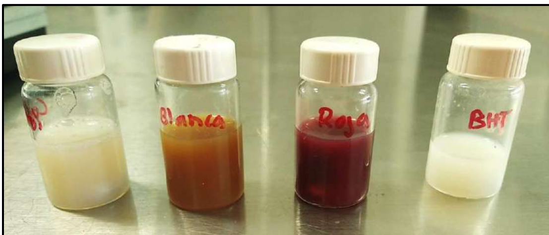
Figura 9. Soluciones poliméricas empleadas, de izquierda a derecha: control, jamaica blanca, jamaica roja y BHT.
