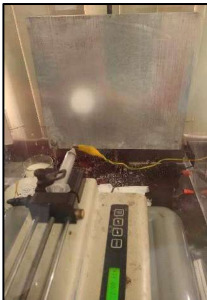
Figura 11. Sistema de electrohilado.
