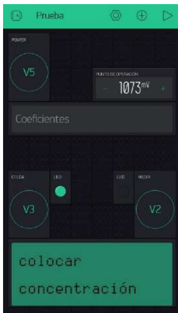
Figura 54. Interfaz de la aplicación para el sensor, creada en Blynk.
