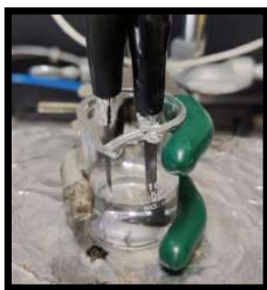
Figura 11. Disposición de los electrodos, sumergidos en la solución preparada para el electrodeposición.
