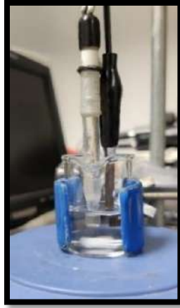
Figura 29. Acomodo de los electrodos, con un electrodo modificado con nanopartículas y cloruros como electrodo de trabajo y electrodo de referencia comercial de Ag/AgCl.
