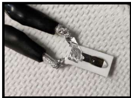
Figura 35. Conexión del arreglo de electrodos modificados con nanopartículas de plata y cloruros para las pruebas de OCP con gotas.
