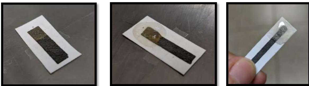
Figura 27. Electrodo modificado, fijo en la mica plástica, antes (izquierda) y después (centro) de depositar el gel de agar, y con la cubierta epóxica (derecha).
