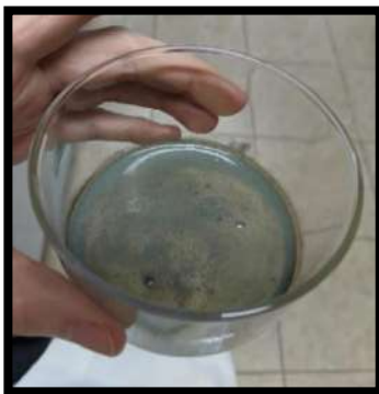
Figura 8. Nanopartículas de plata obtenidas por síntesis química, extraídas en acetona y depositadas en el cristizador.
