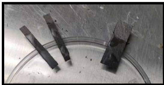
Figura 10. Electrodos de toray, aislados con parafina a excepción del extremo descubierto, a la izquierda electrodos para el electrodeposición y a la derecha el utilizado como contraelectrodo.
