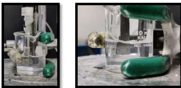
Figura 12. Acomodo de los electrodos para la técnica de voltamperometría cíclica. Con electrodos: referencia de Ag/AgCl, contraelectrodo de grafito y electrodo de trabajo de toray modificado con nanopartículas de plata.
