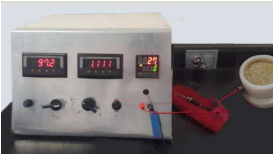
Figura 6. Cocedor Óhmico tipo batch.
