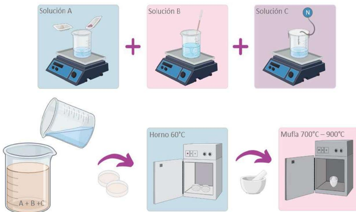
Figura 13 Metodología para la síntesis del silicato de zinc dopado con manganeso por medio del método sol-gel, donde (A) representa la solución de los acetatos, (B) la solución para la sílice y (C) la solución de sulfuro de sodio
