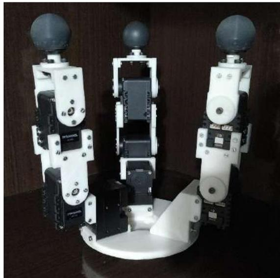
**Figura 3.61** *Ensamble de total de la mano robótica.*
