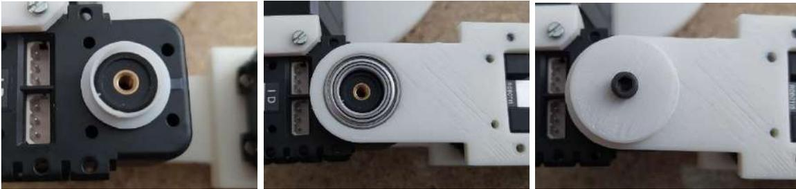
**Figura 3.54** Ensamble de la pieza de ensamble 4 con el primer servomotor AX-A12.
