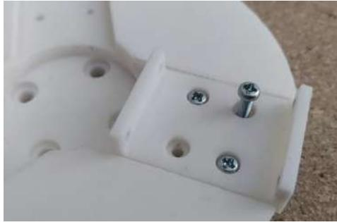
**Figura 3.48** Pieza de ensamble 1 acoplada con la base de la mano robótica.
