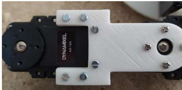
**Figura 3.53** Ensamble del segundo servomotor AX-A12 con la pieza de ensamble 3.
