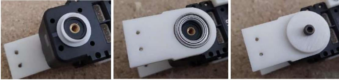
**Figura 3.57** Ensamble de la pieza de ensamble 6 con el segundo servomotor AX-A12.
