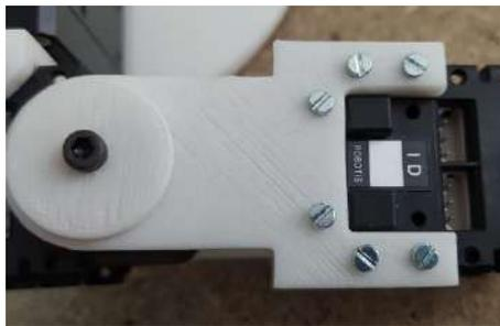
**Figura 3.55** Ensamble de la pieza de ensamble 4 con el segundo servomotor AX-A12.
