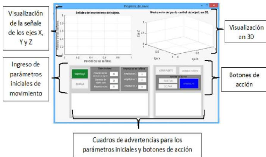
**Figura 4.7** Interfaz de control de la mano robótica.
