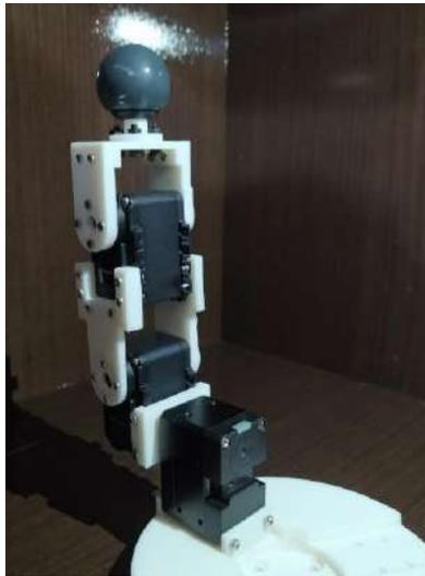
**Figura 3.60** *Ensamble de un dedo de la mano robótica.*
