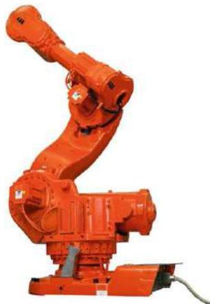
**Figura 2.3** Brazo robótico con arquitectura en serie (Angeles, 2014).
