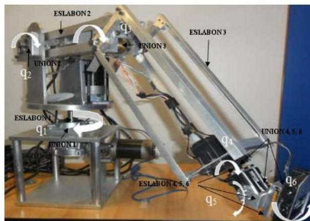
**Figura 2.18** Robot de seis grados de libertad construido, con una vista de sus articulaciones (M.C. González Gutiérrez, 2013).
