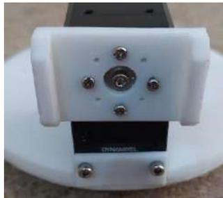
**Figura 3.50** Ensamble de la pieza de en ensamble 2 con el servomotor XM-430-W210.
