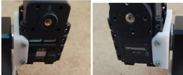
**Figura 3.51** Ensamble del servomotor AX-A12 con la pieza de ensamble 2.
