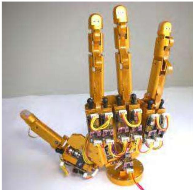
**Figura 2.5** Mano robótica diestra con actuadores lineales (Kim, Lim, & Lee, 2010)
