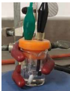
Figura 3 Sistema de electrodos colocados en el Potenciostato
