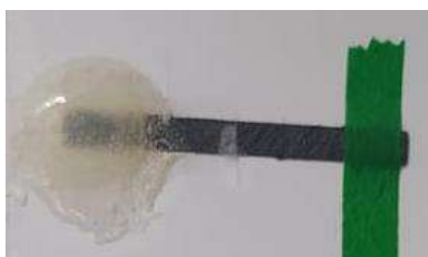
Figura 22 Electrodo de referencia de Ag/AgCl para biosensor de glucosa tipo parche
