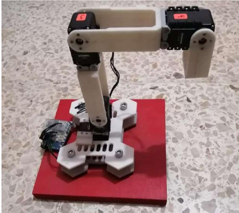
**Figura 4.5.** Robot manipulador serial montado con los eslabones impresos, los actuadores Dynamixel AX-12, el módulo U2D2 y la base de apoyo.
