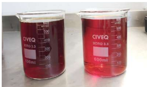
Figura 6 Muestra tratada antes (izquierda) y después (derecha) de la filtración. 6.5 PAO
