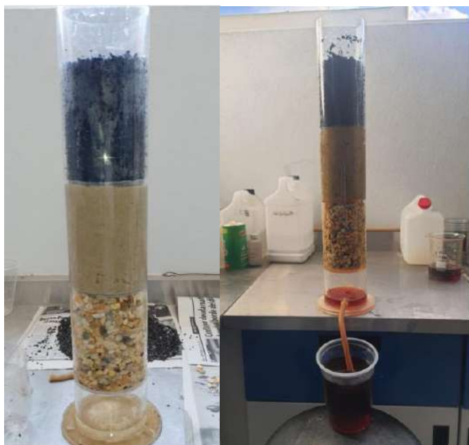
Figura 26 Sistema de filtración empacado con carbón activado, arena y grava sílica, con 10 cm de cada componente.
