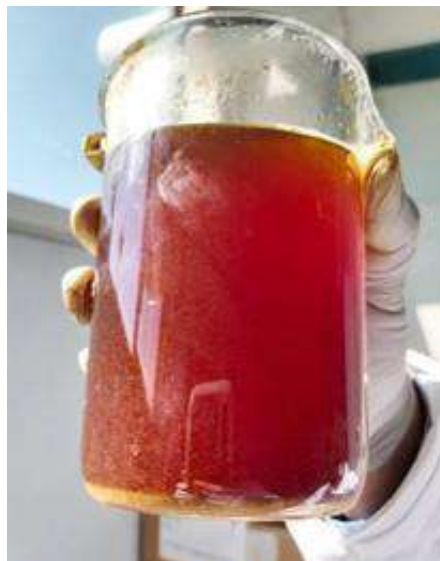
Figura 13 Sedimentación de sólidos siguiendo la metodología de prueba de jarras de la corrida dos.
