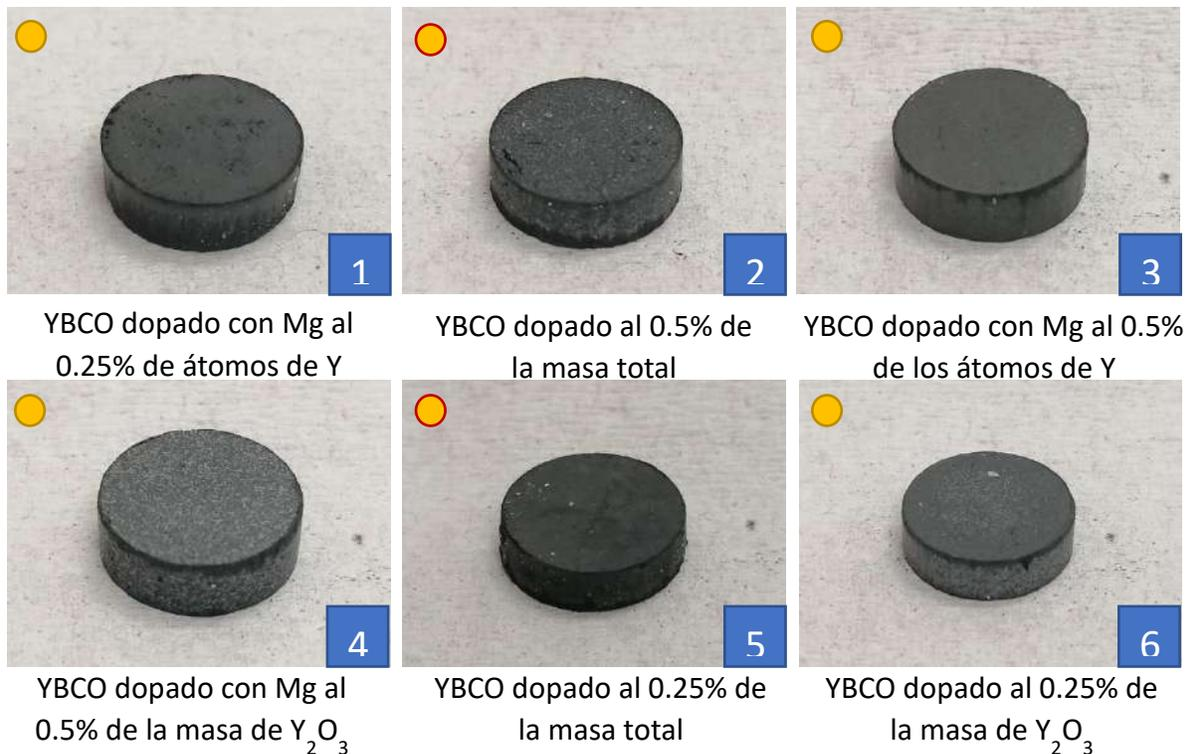
**Figura 23:** Superconductores que dieron positivo a las pruebas de efecto Meissner.
