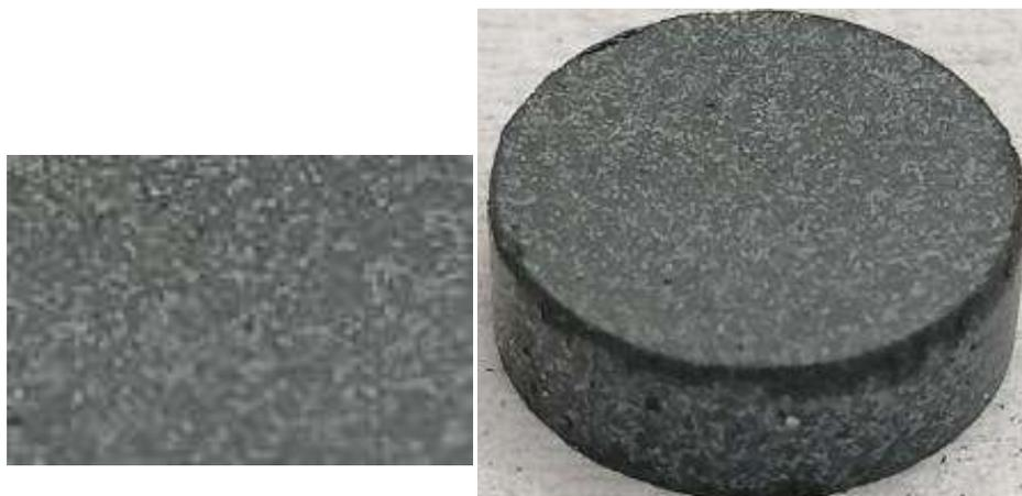
**Figura 24:** Muestra que presenta una textura blanquecina en su superficie como resultado de la sinterización.
