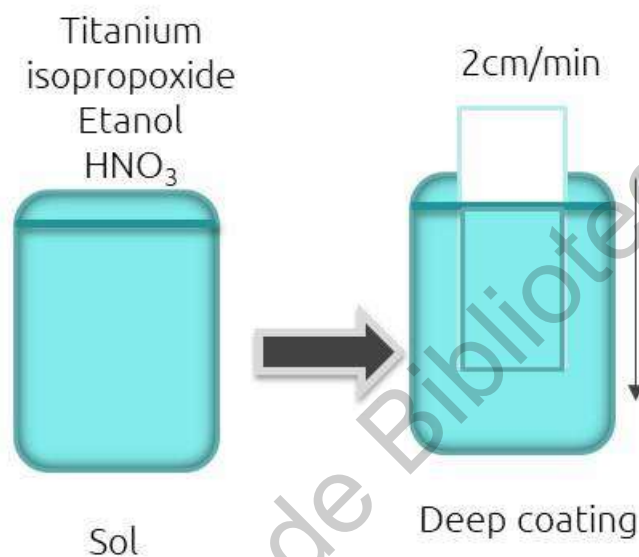
Figura 9. Esquema de depósito de películas delgadas de TiO_2 por la técnica de inmersión remoción.
