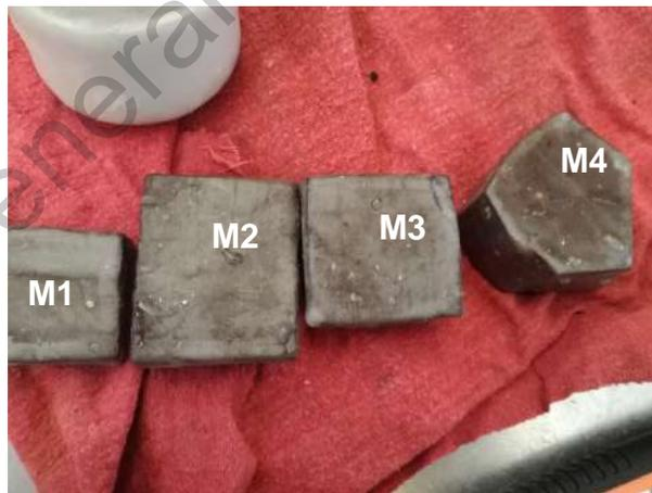
Figura 3.5. Muestras densas cubiertas con parafina para la determinación de su volumen.
