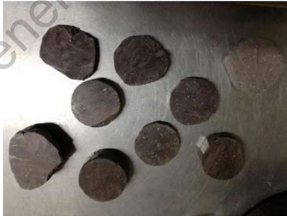
Figura 3.3. Especímenes de suelo de densidad relativa compacta labrados para medición de succión.
