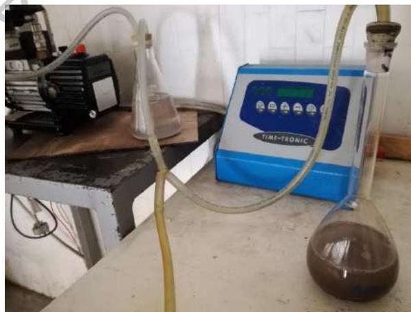
Figura 3.1. Extracción de aire para la determinación de la densidad de sólidos.
