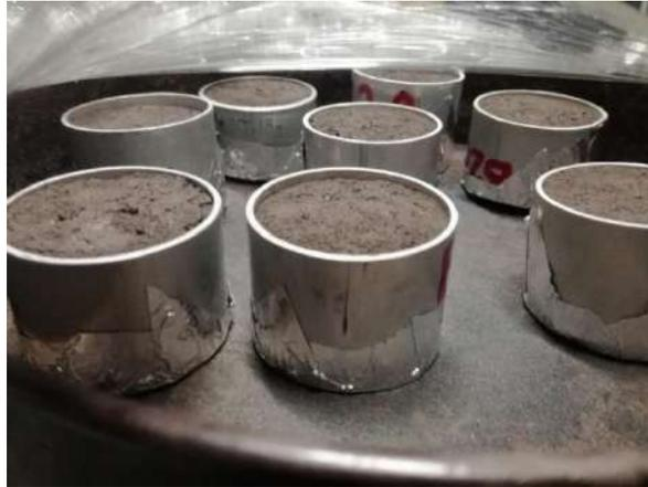
Figura 3.2. Muestras sueltas para la determinación de la curva de succión humedecimiento – secado.
