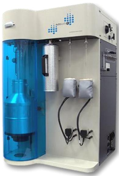
**Figura 3.4** Equipo autosorb Quantachrome iQ2
