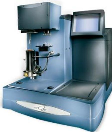
**Figura 3.7 Equipo TGA Q500 TA Instruments**
