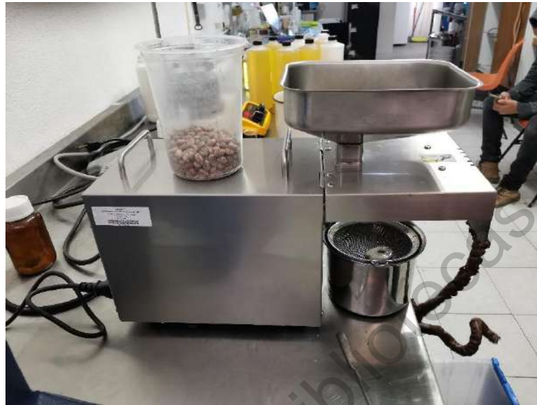
Figura 14. Proceso de obtención de aceite en prensado mecánico en caliente
