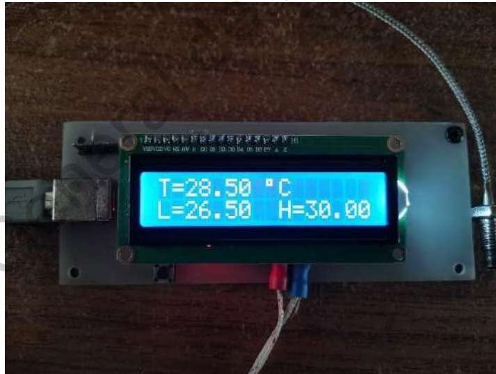
Figura 9. Funcionamiento del sistema de medición de temperatura y termopar
