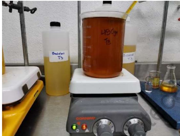
Figura 18. Reacción de transesterificación en lote de 450 gr
