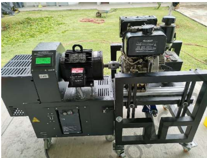
Figura 3. Motor para pruebas de Biodiésel con medidor de torque integrado
