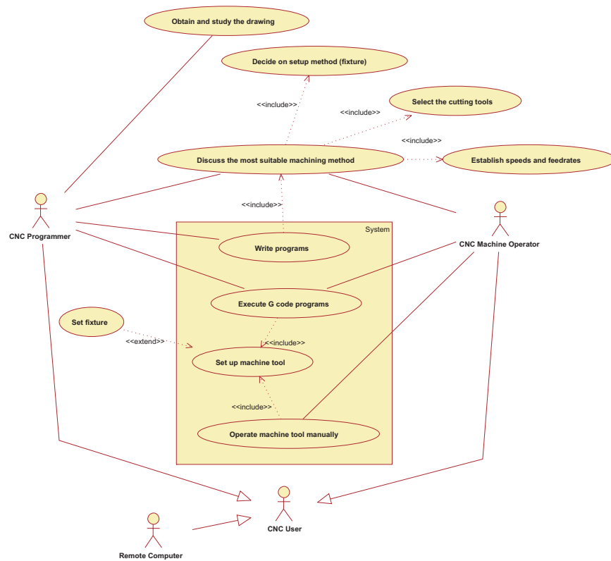
Figura 3.3: Caso de uso general para un sistema de CNC.
