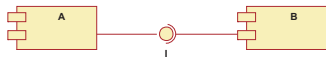
Figura 5.2: El componente A provee de información al componente B por medio de la interfaz I .
