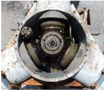
Figura 19. Control de ángulo de paso.
