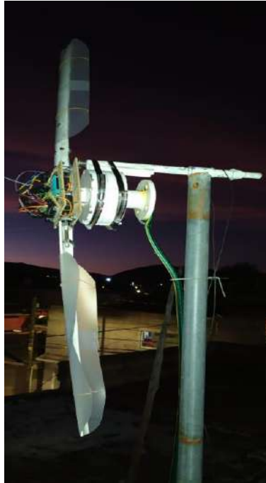
Figura 4.21 Generador eólico y circuito para control de ángulo de pitch montado en posición para la medición.
