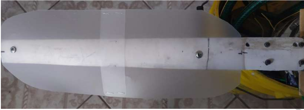
Figura 4.47 Modificaciones hechas para las palas y captar mejor el flujo del sistema.
