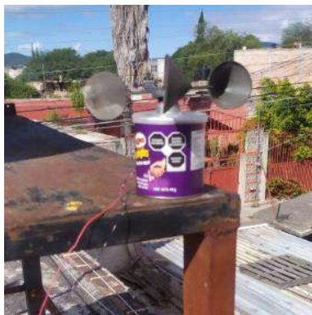
Figura 4.38 Anemómetro construido montado en posición para lecturas de velocidad.
