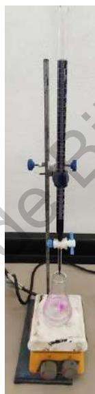
Figura 8. Equipo para cuantificación de sulfato ferroso.
