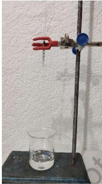
Figura 7. Sistema de elaboración de microcápsulas de alginato de sodio.
