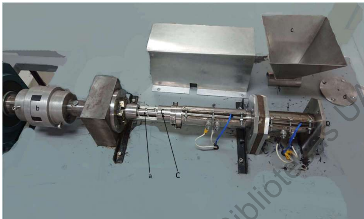
Figura 3. Extrusora perteneciente a la Universidad Autónoma de Querétaro. (a) Tornillo de acero (b) Motor (c) Tolva de alimentación (C) Lugar de ubicación de la tolva de alimentación (d) Dado formador de pellets (D) Ubicación del dado (e) Primer zona de calentamiento (f) Segunda zona de calentamiento.
