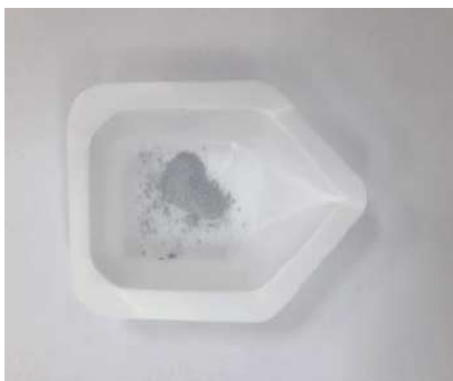
Figura 17. Polvos de \text{InTaO}_4/\text{OG} obtenidos mediante incorporación asistida por ultrasonido.
