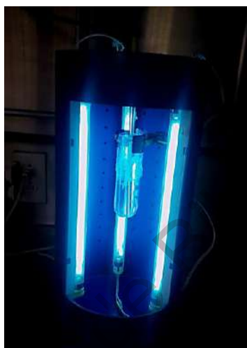
Figura 20. Montaje del fotoreactor prototipo para la fotoreducción de \text{CO}_2 a metanol.
