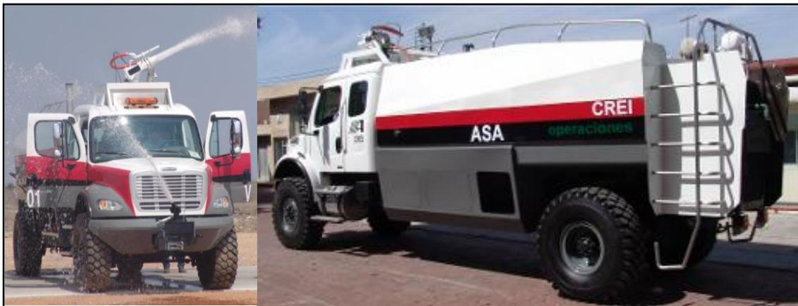
Figura 5. Vehículo de rescate aeroportuario. Fuente CIATEQ (2008). Proyecto desarrollado para ASA por el Centro Público de Investigación CIATEQ en el 2008. Se desarrollaron 7 prototipos de este vehículo, con la finalidad de atender incendios en el interior de un aeropuerto.
