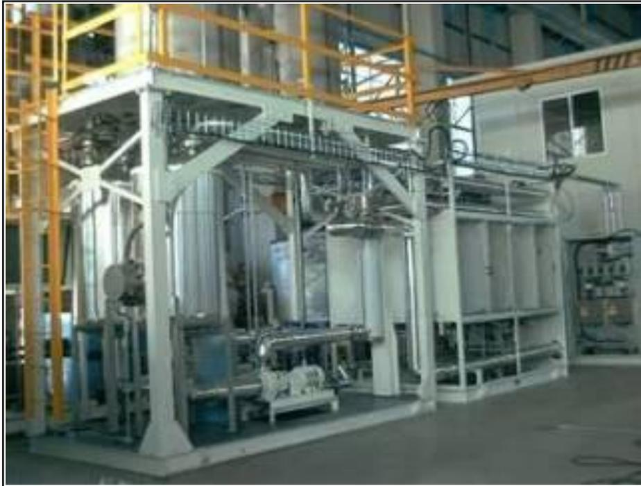
Figura 6. Máquina para pruebas de radiadores automotrices. Fuente CIATEQ (2008). Proyecto desarrollado en el 2004 para la empresa automotriz Valeo Térmico por el Centro Público de Investigación CIATEQ. Esta máquina es capaz de realizar pruebas de ciclos térmicos con temperaturas que van desde  $-15\text{ }^{\circ}\text{C}$  hasta  $110\text{ }^{\circ}\text{C}$  en radiadores automotrices.
