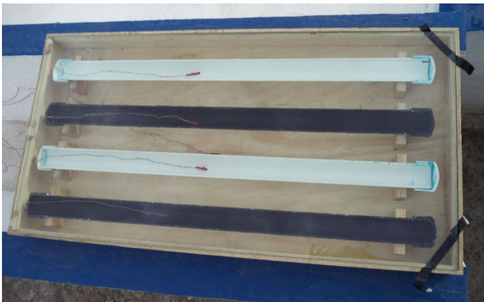
Figura 4-8. Modelo físico construido para evaluar el efecto de la radiación solar para desinfectar el agua pluvial.
