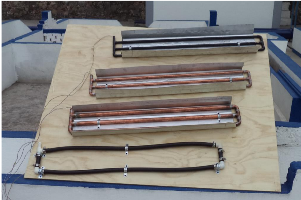
Figura 4-7. Modelo físico construido para evaluar aumento de la temperatura.
