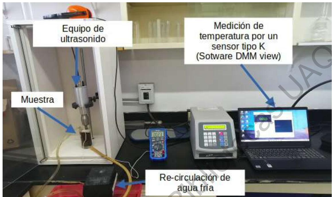
Figura 10: Equipo Cole-Parmer Ultrasonic Cleaner, Heater/Digital Timer con adaptaciones para una re-circulación de agua fría y la medición de temperatura con un sensor termopar tipo K.
