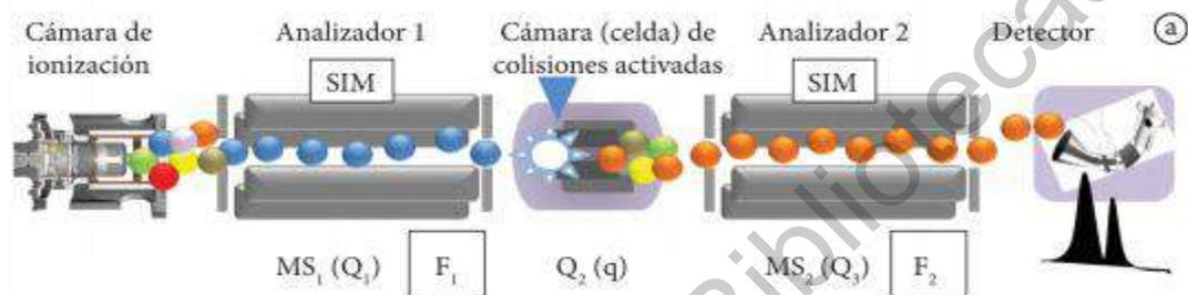
Figura A10 esquema del proceso de análisis GC-MS. Imagen recuperada y adaptada de <http://doi.editoracubo.com.br/10.4322/sc.2012.010>
