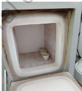
Figura 13. Muestras dentro de la mufla
