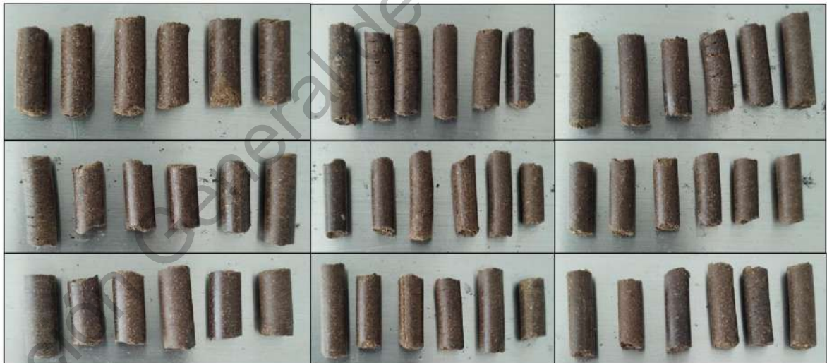
Figura 25. Pellets de 0.42 mm con 25 % (lado izquierdo), 27 % (centro) y 30 % (lado derecho) de humedad
