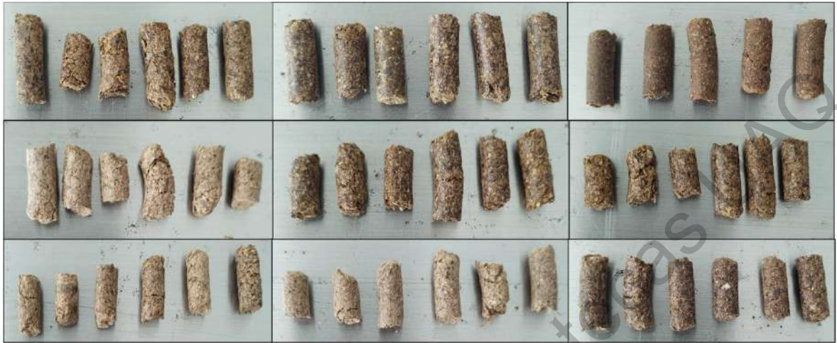
Figura 26. Pellets de 1.00 mm con 25 % (lado izquierdo), 27 % (centro) y 30 % (lado derecho) de humedad
