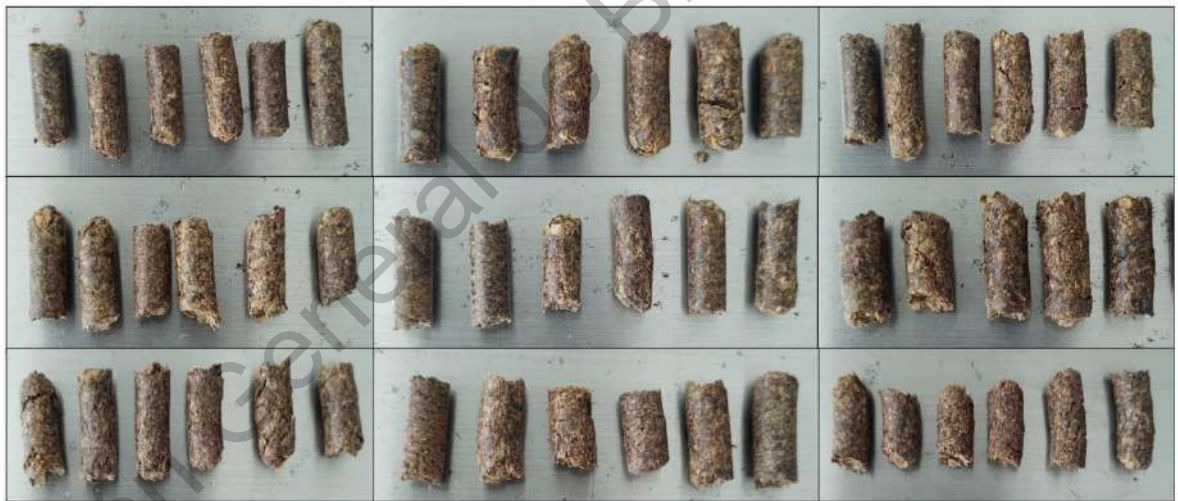
Figura 27. Pellets de 3.00 mm con 25 % (lado izquierdo), 27 % (centro) y 30 % (lado derecho) de humedad
