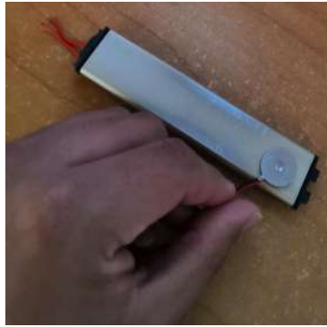
(a) Adaptar piezoeléctricos a plancha.
