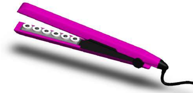
Figura 4.11: Dibujo de la secadora ultrasonica en SolidWorks.
