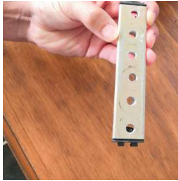
(b) Agujeros en placa de plancha para los piezoeléctricos.
