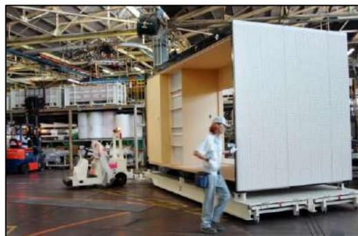
**Figura 6.** Línea de ensamblaje de viviendas prefabricadas de la compañía Toyota (Smith, 2009).
