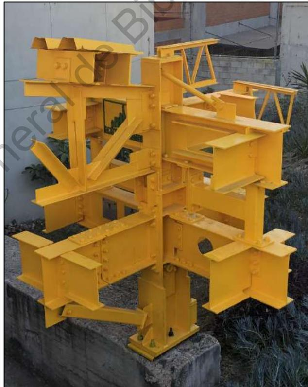
**Figura 27.** Árbol de conexiones del Colegio de Ingenieros Civiles del Estado de Querétaro (CICQ) que ilustra la variedad de algunas conexiones distintas que se pueden tener en una estructura (Rodríguez, 2019).
