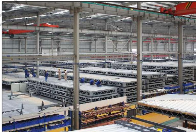
**Figura 46.** Fabricación de los entrepisos para el edificio «T-30» en la fábrica BSB (Sheldon, 2012).
