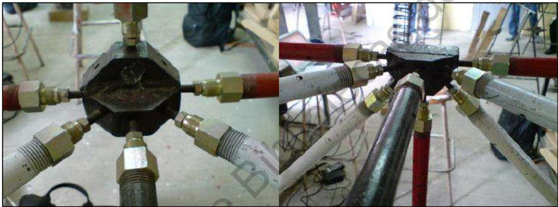
**Figura 32.** Conector universal donde se unen hasta 8 elementos de la armadura (Ruiz, 2009).
