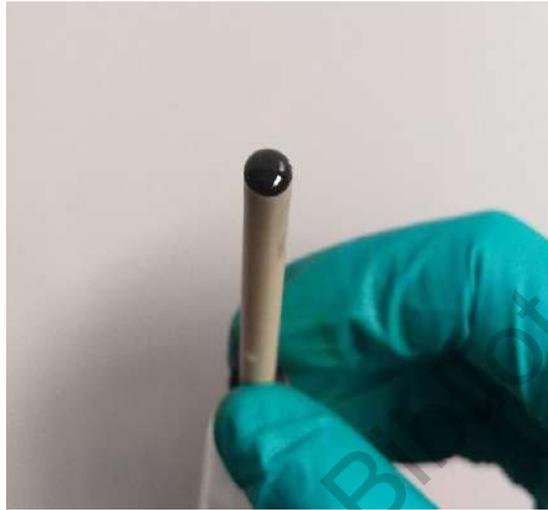
Figura 4. Recubrimiento de nanotubos de carbono multipared sobre ecv.
