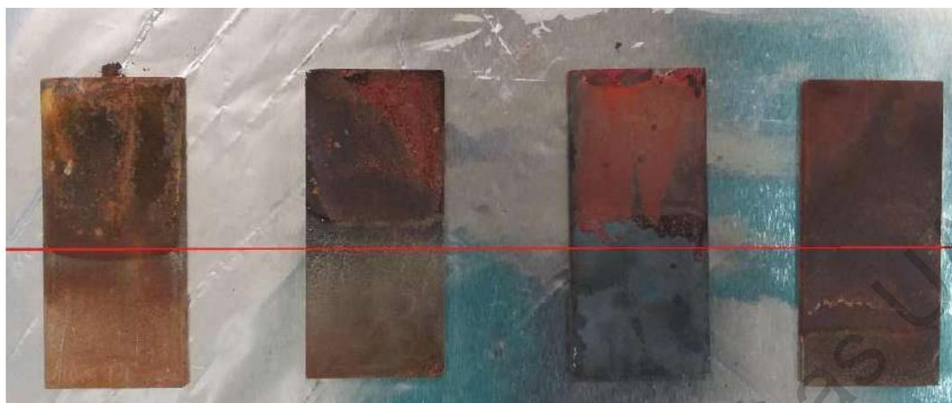
Figura 49. Electrodos después del uso de la remediación en agua.
