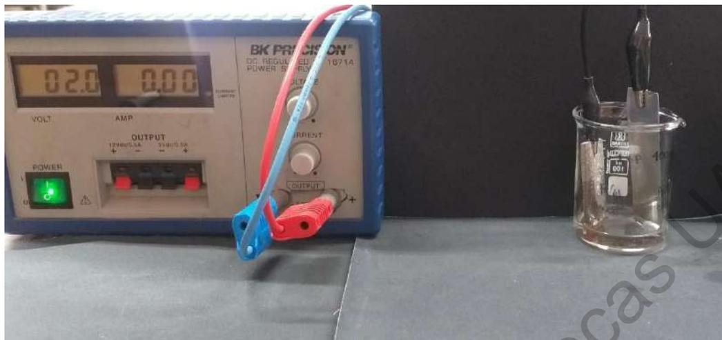
Figura 16. Celda cilíndrica para la remediación de agua modelo contaminada.
