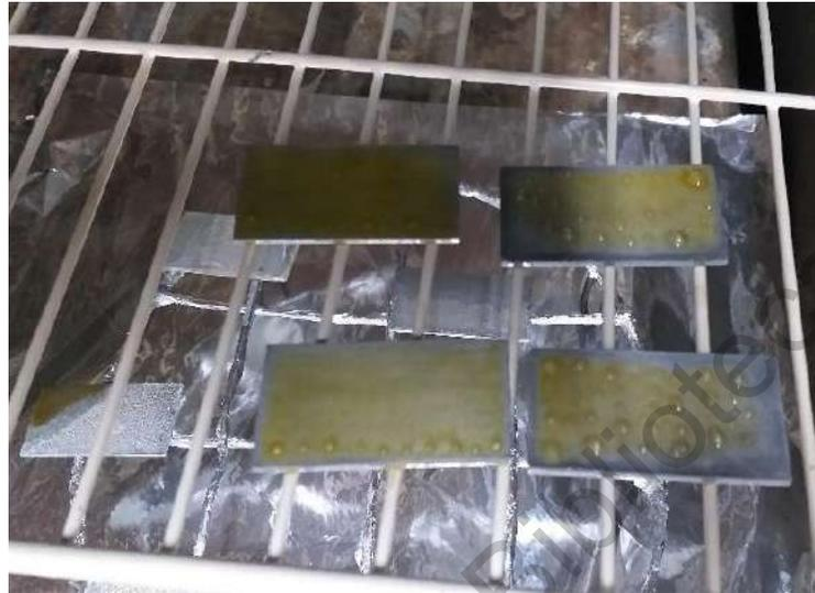
Figura 11. Secado de placas recubiertas en horno a 80° C.
